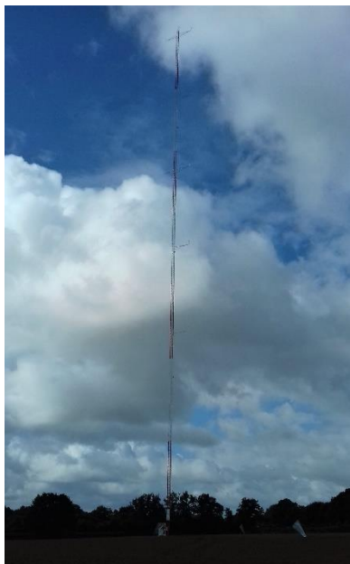
Figure 8 : Mât de mesures anémométriques du projet du parc de Louin (Crédit photo : EOLISE)
